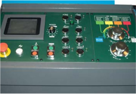
Контрол панел с цветен тъчскрийн екран и ръчни бутони NC - серии
